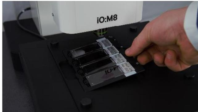
Figura 7-2: posizionare il vassoio sotto al microscopio
