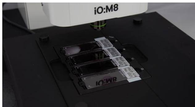
Figura 7-3: Posizione finale del vassoio sotto al microscopio
